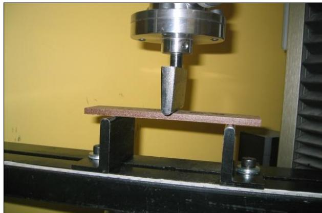
Figure 3.8 : Test de flexion à 3 points
